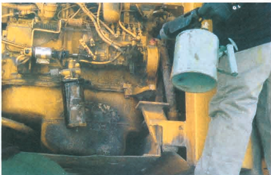
Benzin-brænderen var et meget vigtigt redskab, når blandt andet motorolien i kranen skulle varmes op.
